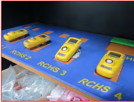
ภาพที่ 2.2-1(57) เครื่องตรวจวัดไฮโดรเจนซัลไฟด์ ชนิดถือหิ้ว (Portable H 2 S Analyzer)
