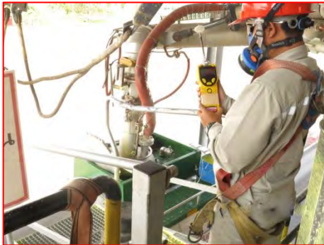
ภาพที่ 2.2-1(14) การตรวจวัดสารอินทรีย์ระเหย ขณะการสูบน้ำสารอินทรีย์ด้วยเครื่องวัดแบบพกพา
